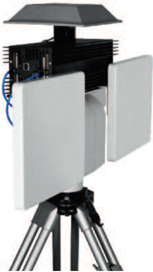
Рис. 4. Общий вид макета экспериментального ЛЧМ-радара
