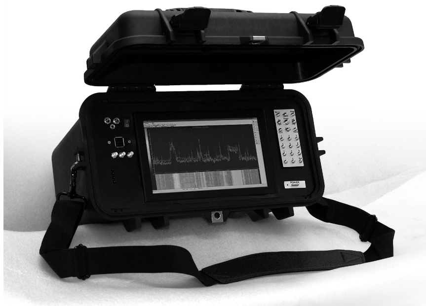
Рисунок. Поисковый анализатор спектра Spectrum Jet с программным переключением антенн диапазона частот от 9 КГц до 19 ГГц (встроенные – внешние). Скорость анализа свыше 5-ти ГГц в секунду с разрешением 10 КГц. Автономная работа до 3-х часов. Съемная крышка. Вес около 6 кг
