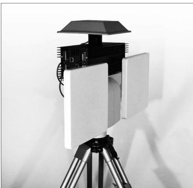
Рис. 3. Макет радара 9,4 ГГц с антенными решетками (8×8 патч-элементов)
