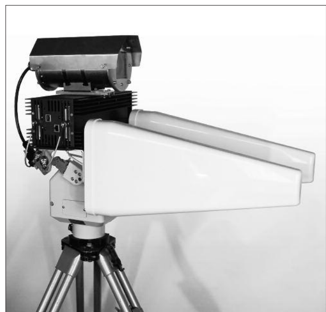
Рис. 4. Система радиоэлектронного подавления с наведением ОЭС
