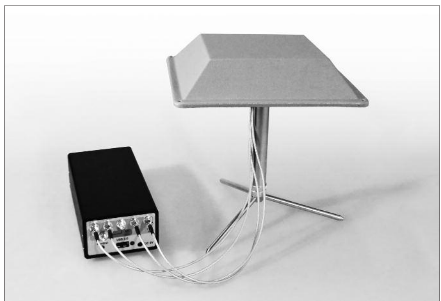
Рис. 1. Мониторинговый приемник «Радриан» со встроенным коммутатором на 4 входа и с четырьмя антеннами диапазона 2,0...6,0 ГГц (4 сектора по 90°)
