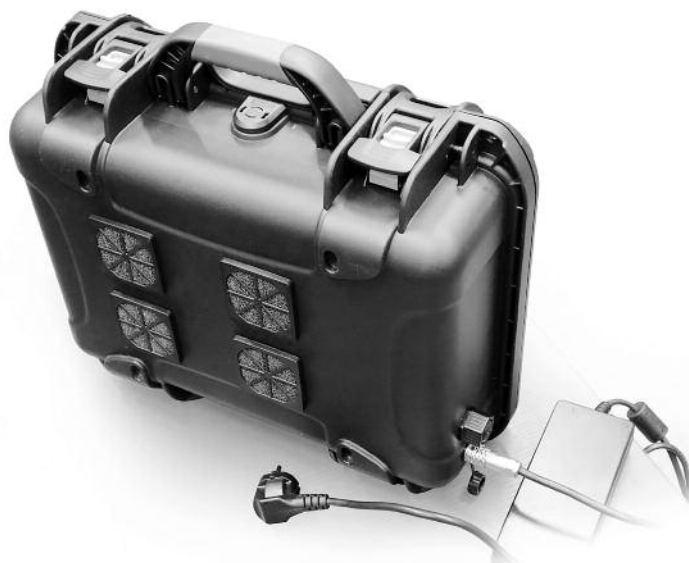
Рис. 1. Блок подавления располагается в радиопрозрачном пластиковом кейсе
