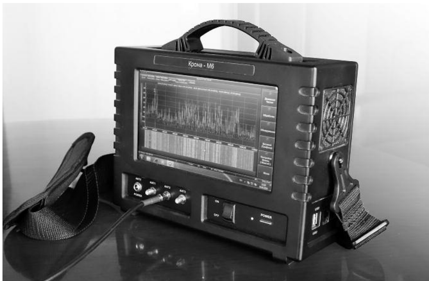
Рис. 3. Портативный анализатор спектра реального времени «Крона-М»
