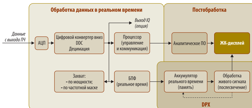
Рис. 1. Обобщенная структурная схема анализатора спектра реального времени
