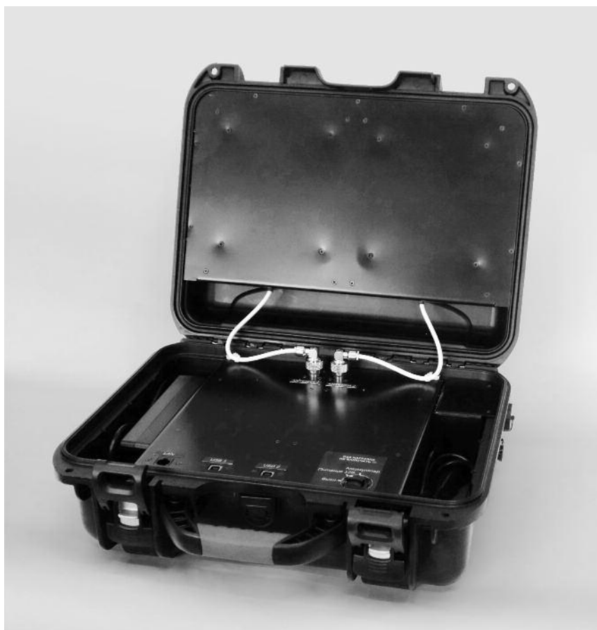
Рис. 2. Смонтированный в кейсе портативный подавитель
