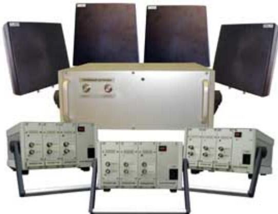
искл<sup>ю</sup>чить возможность пользования сотовыми телефонами. Каждое помещение оборудуется интеллектуальными блокираторами RS SpiderCell для сетей сотовой связи действующих стандартов. Все блокираторы объединяются в локальную сеть CAN (Controller Area Network).
